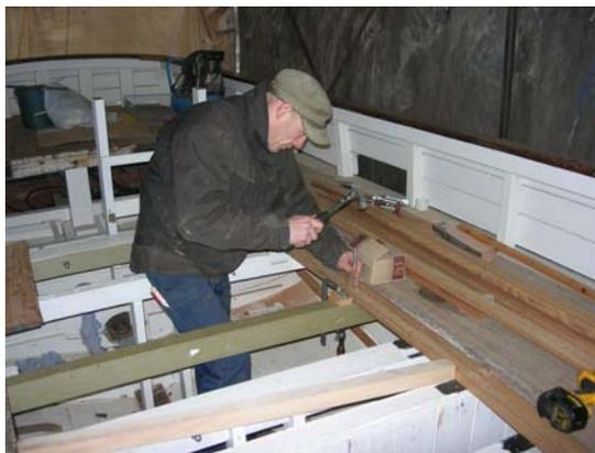
De latten worden op de dekbalken genageld met staalnagels.. Het vraagt heel wat aandacht om ze strak tegen elkaar te plaatsen daar ze allemaal in een lichte kromming worden gelegd. Er is trouwens heel wat kracht voor nodig.
