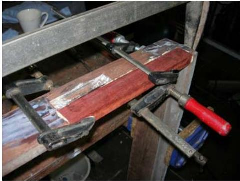
Als lijm en vulmiddel gebruiken we **Thixotrope Epoxy 2 comp van Variobond met als mengverhouding 67/33**
