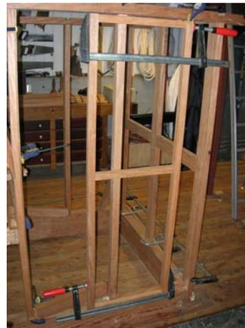
Waar we kunnen, recupereren we de oorspronkelijke onderdelen. Beschadigde stukken worden verwijderd en 'vakkundig' hersteld door er een bvb. een "nieuw stuk" in te steken. Dat gebeurt hier bij het luik van het motorcompartiment.
